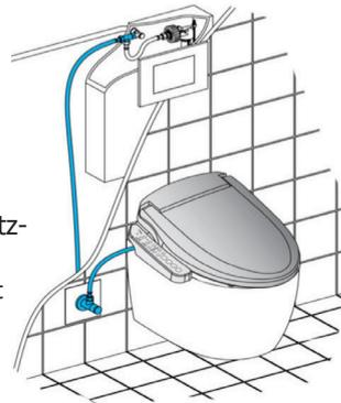
Installation an einem Unterputz-spülkasten, mit vorhandenem Leerrohr. (Unterputz-Anschlußset separat bestellbar)
